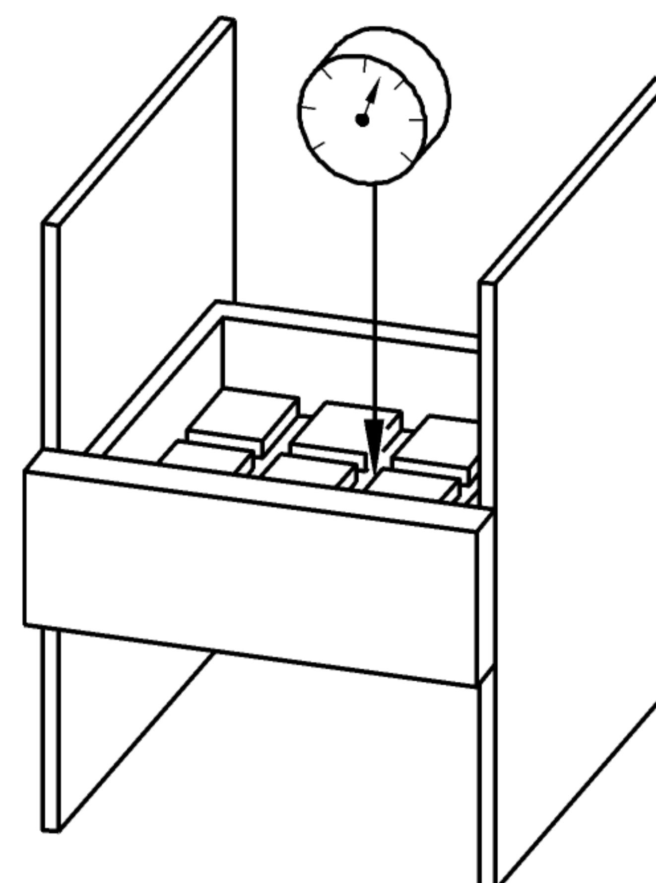
Рисунок 6 — Нагрузка дна выдвижного элемента
