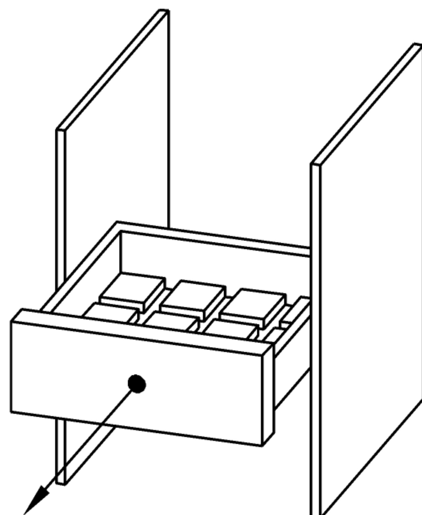
Рисунок 5 — Статическая нагрузка при выдвижении
