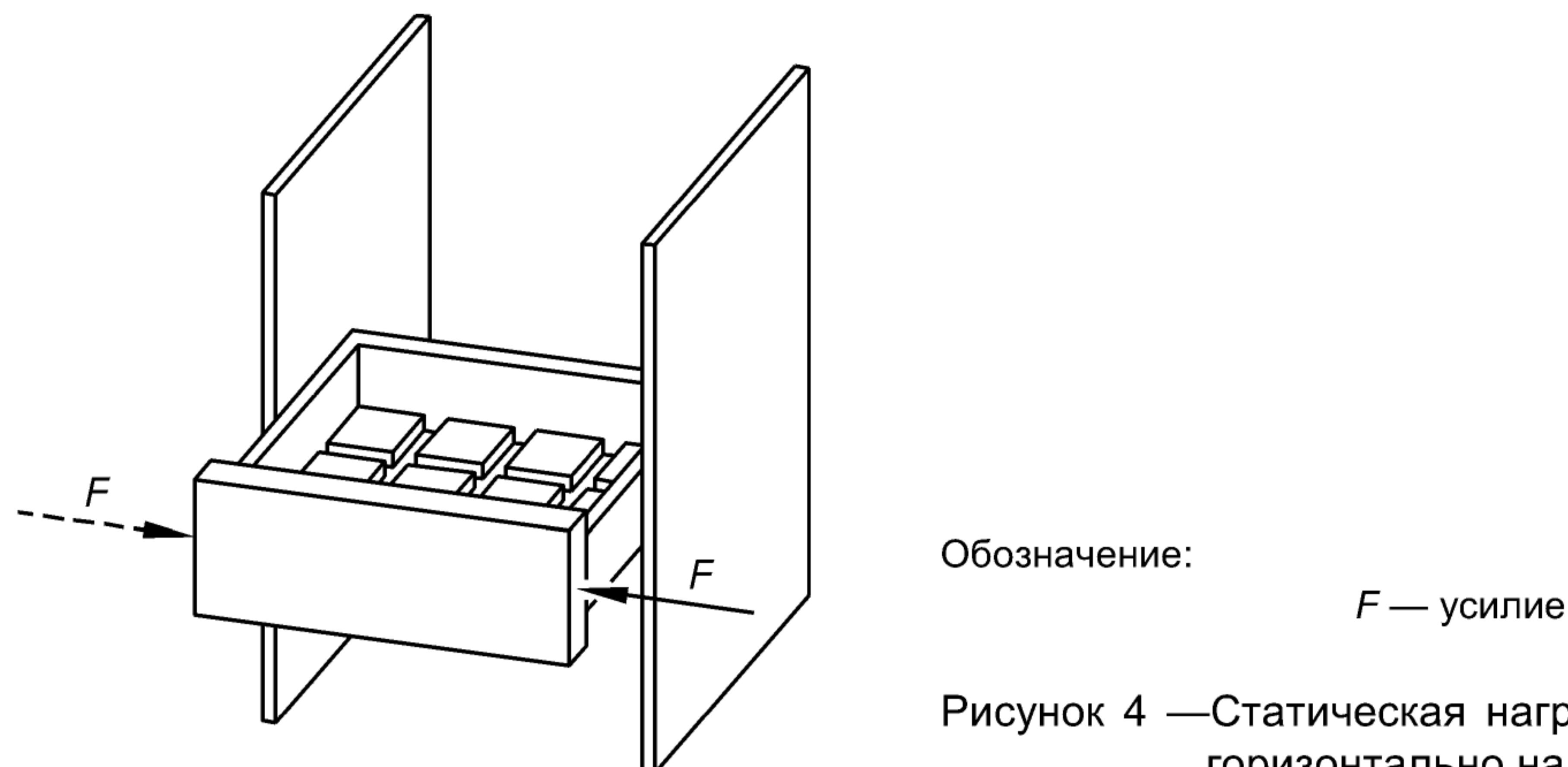
Рисунок 4 —Статическая нагрузка, направленная горизонтально на кромку
