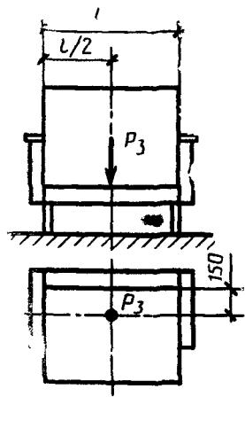
Схема испытания многоместного изделия
